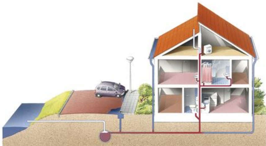
Een gemengd stelsel: hemelwater en afvalwater worden via eenzelfde riool afgevoerd naar de waterzuivering.
